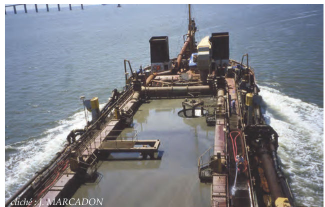
Fig. 2 - Basse Loire : la drague « Vladeren XX » va clapet au large le contenu de son bac de 5 000 m 3
